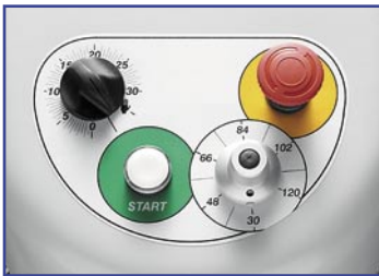
Pannello di comando "C-line V.V" : Timer, variatore elettronico.
